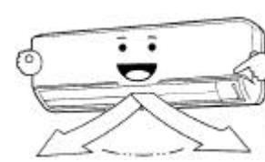
Перед установкой: Путем использования пульта ДУ, перевести вертикальные жалюзи в вертикальное нижнее положение. \* Вручную настроить направление горизонтального потока воздуха.
